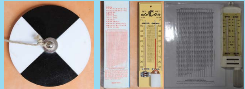
ภาพที่ 3. เซคคิติดิสก์ (ซ้าย) และเครื่องวัดความชื้นสัมพัทธ์ (ขวา)
